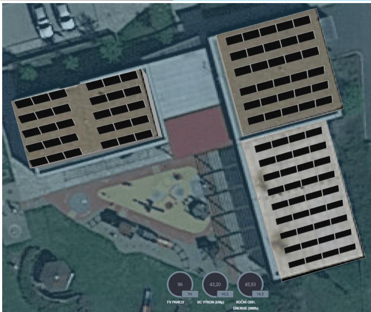
Obr. č. 2 Umístění FV panelů na střeše MŠ Úholičky
